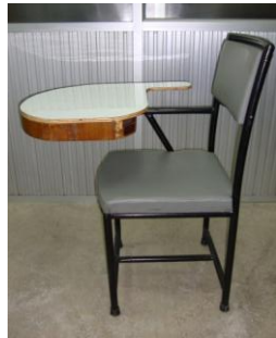
รูปที่ 4 โครงสร้างของโต๊ะเรียนที่ออกแบบปรับปรุงใหม่ด้านขวา
