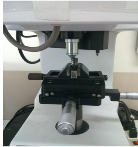
รูปที่ 7 แสดงการวัดค่าความแข็งของชิ้นงานทดสอบบนเครื่องทดสอบความแข็ง
