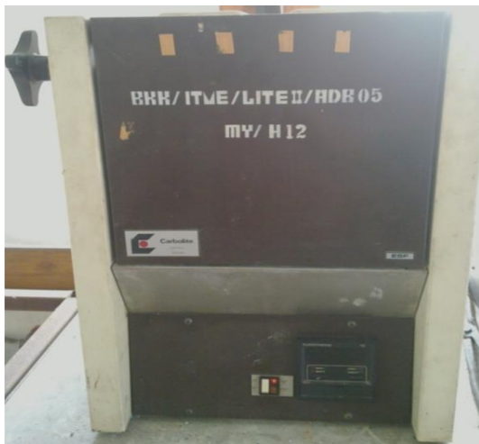
รูปที่ 6 เตาที่ใช้ในการอบชุบชิ้นทดสอบ
