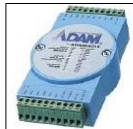
DAQ-ADAM 4018 (IBCON CO.,LTD) และโปรแกรมใช้งานแล็บวิว (LabVIEW) ที่พัฒนาขึ้น
