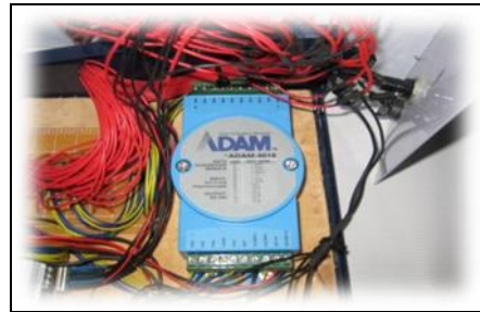
รูปที่ 3 วงจร Wheatstone bridge ของสเตรนเกจต่อเข้ากับ DAQ-ADAM 4018 ( \epsilon_{ms} = \epsilon_o = 4e_o / E K_s )
